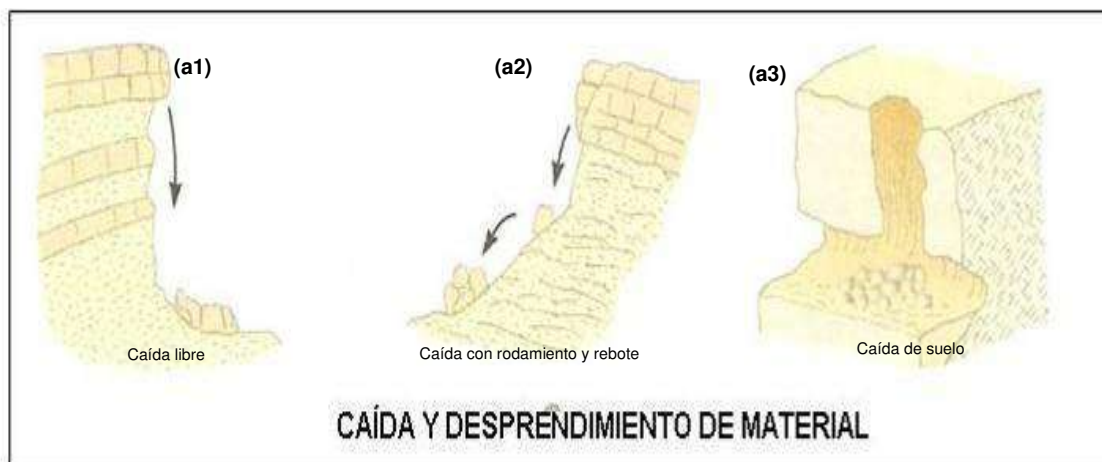
Figura 40 Remociones en Masa de tipo Caídas de Rocas
